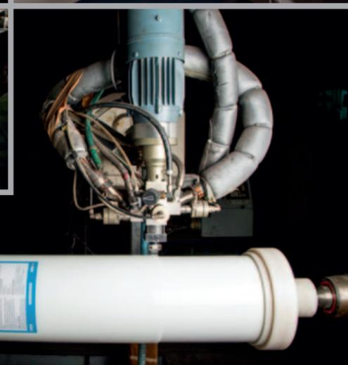
In unseren drei Produktionsstätten fertigen wir Walzenbeschichtungen und entwickeln für unsere Kunden Beläge präzise nach Maß und Anforderungsprofil. Für extreme Belastungen beschichten wir Walzen mit PU-Elastomeren, die durch ihre besondere Abrieb- und Weiterreißfestigkeit eine lange Lebensdauer haben. Unsere Beläge erreichen bis 65 ShoreD-Härte und halten Dauer-temperaturbelastungen bis 120 °C aus. Wir greifen auf bewährte Mischungen zurück – oder entwickeln für Sie eine neue Rezeptur.
