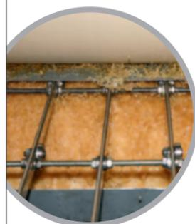
**INFO\_**VNP-Walzen sorgen in der Stahl- und Aluminiumindustrie für einen gleichmäßigen und streifenfreien Film in Einölanlagen. Als Abquetschwalzen werden sie in Walzwerken wie auch in Beiz- und Entfettungsanlagen eingesetzt. In der Automobilindustrie sind unsere VNP-Walzen überall dort im Einsatz, wo es auf beste Ergebnisse beim Abquetschen von Waschfluiden und die Entfernung von Restpartikeln in der Band- und Platinenreinigung ankommt und gleichmäßige Ölfilme zum Pressen benötigt werden.
