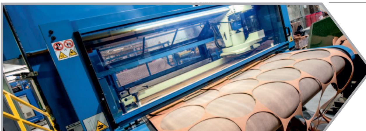
**Stanzan** Aus der Vliesstoff-Rohware werden im ersten Schritt Ronden ausgestanzt. Eine rechnergesteuerte Stanzmaschine bewirkt die bestmögliche Ausnutzung des Materials. Die geometrische Gestaltung ist dabei völlig frei, so dass beliebige vorhandene Kernquerschnitte beschichtet werden können. Nach dem Stanzen werden die Ronden manuell zum Pressen gestapelt.
