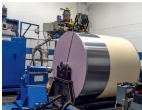
S-Rolle (2,10 m Ø) bei der PU-Beschichtung in unserem Werk in den USA
