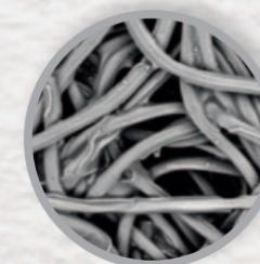
**INFO** Die poröse Vliesstoffmatrix in Verbindung mit der speziell abgestimmten Härte des Binders sorgt bei VNP-beschichteten Walzen für einen gleichmäßigen Auftrag der flüssigen Medien und für eine erstklassige Abquetschleistung. VNP-Walzen sind widerstandsfähig gegenüber Schnitten durch scharfe Bandkanten und deshalb von hoher Gebrauchsdauer.
