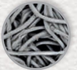
**INFO\_** Die poröse Vliesstoffmatrix in Verbindung mit der speziell abgestimmten Härte des Binders sorgt bei VNP-beschichteten Walzen für einen gleichmäßigen Auftrag der flüssigen Medien und für eine erstklassige Abquetschleistung. VNP-Walzen sind widerstandsfähig gegenüber Schnitten durch scharfe Bandkanten und deshalb von hoher Gebrauchsdauer.
