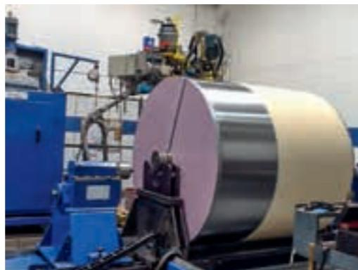
S-Rolle (2,10 m Ø) bei der PU-Beschichtung in unserem Werk in den USA
