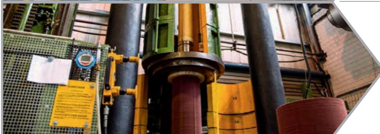
**Pressen** Anschließend werden die Ronden auf den Walzenkern gepresst. Dabei wird auf eine gleichmäßige Dichte und Härte über die ganze Ballenlänge geachtet. In besonderen Fällen werden die Ronden untereinander verklebt, um die mechanische Widerstandsfähigkeit der Beläge noch weiter zu verbessern. Hierzu muss das Ausgangsmaterial mit einem Kleber ausgerüstet sein, der nach dem Pressen des Belags durch Tempern aktiviert wird.
