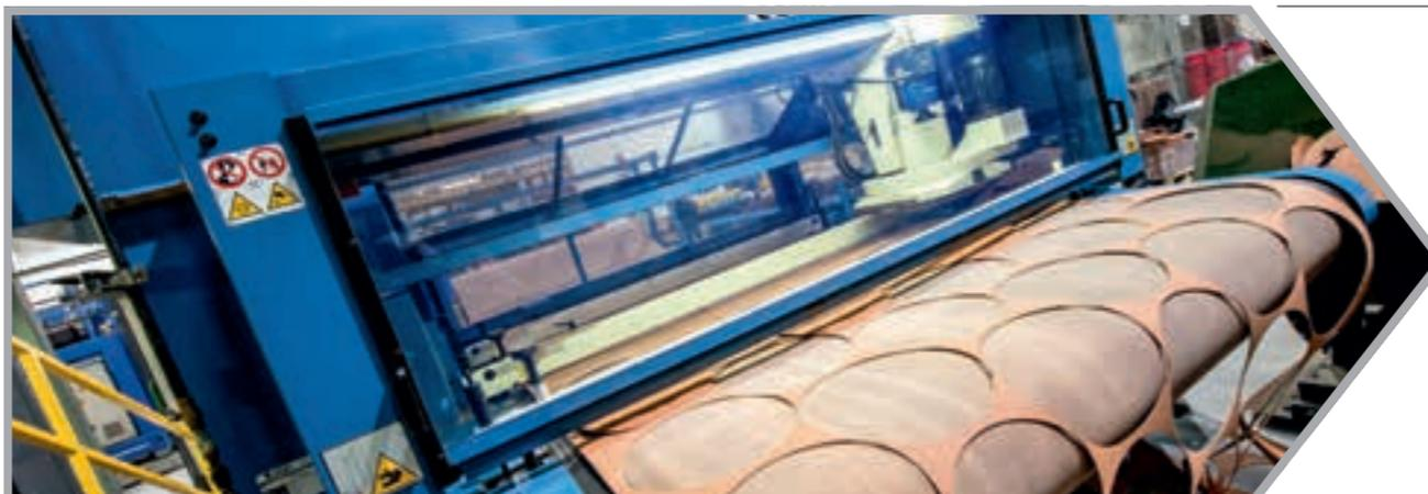
**Stanzen** Aus der Vliesstoff-Rohware werden im ersten Schritt Ronden ausgestanzt. Eine rechnergesteuerte Stanzmaschine bewirkt die bestmögliche Ausnutzung des Materials. Die geometrische Gestaltung ist dabei völlig frei, so dass beliebige vorhandene Kernquerschnitte beschichtet werden können. Nach dem Stanzen werden die Ronden manuell zum Pressen gestapelt.
